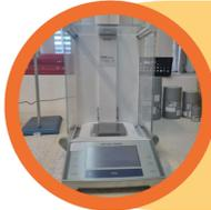
La balanza se debe encontrar en una superficie estable, sin vibraciones y libre de corrientes de aire.
