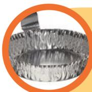
Seleccionar el material adecuado para el tipo de sustancia que se va a pesar, por ejemplo, naves, papel glassine, cápsulas de aluminio, entre otras.
