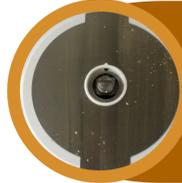
Verificar que el plato de carga esté libre de residuos y suciedad para evitar impactar en la medición y en el instrumento.
