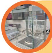
Es importante cerrar correctamente las puertas de la balanza para evitar el paso de corrientes de aire.
